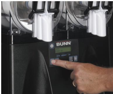
Paso 1: En preparación para la limpieza de la máquina, apagar la función de auto-relleno pulsando el "botón sinfín" ("auger button") hasta que en la pantalla se lea "sinfín prendido" ("auger on"). El auto-relleno tendrá que estar apagado por un período predeterminado de tiempo antes de empezar la limpieza. Esto dependerá de su volumen pronosticado por el resto del día.
