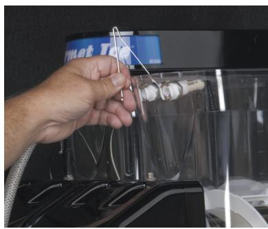
Paso 8: Vuelva a colocar la sonda de relleno automático a la tolva. Luego coloque la tapa de la tolva de nuevo en la parte superior de la tolva. Enchufe la lámpara de la tapa. Vuelva a conectar el concentrado y las líneas de agua a la parte trasera de la tolva. Vuelva a colocar la bandeja de goteo y poner la rejilla en su lugar.
