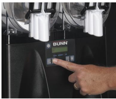
Paso 9: Prenda la opción auto-relleno pulsando el "botón sinfín" ("auger button") hasta que en la pantalla aparezca "sinfín izquierdo prendido" ("left auger refill on"). Luego encender la refrigeración pulsando el "botón copo de nieve" ("snowflake button") hasta que en la pantalla diga "hielo" ("ice").
