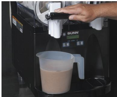
Paso 3: Vacíe el producto de la tolva de una manera que no queden residuos del producto. Añadir agua tibia para ayudar a eliminar el exceso de producto si es necesario. Todo el producto que se ha vaciado debe ser dispensado en la basura y no se debe utilizar de nuevo. Repita el mismo proceso con la otra tolva si es necesario.
