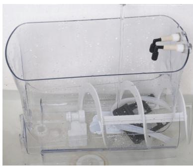
Paso 6: Si usted no está usando la lavadora de platos, coloque todas las piezas desmontadas en el fregadero para lavarse con agua tibia y jabón. Una vez que todas las piezas se hayan lavado colocarlas en un baño de saneamiento Kay-5 y dejarlas en remojo durante varios minutos. Mientras las piezas se remojan, limpiar el exterior de la máquina, tambor de enfriamiento, bandeja de goteo de la tolva y la sonda de auto-relleno con un trapo limpio y humedecido con agua tibia.
