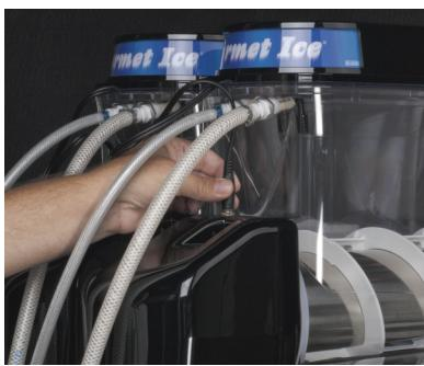
Paso 4: Comience el proceso de desmantelamiento de la tolva al desenchufar la tapa de la lámpara. Luego desconecte el concentrado y las líneas de agua. Retire la tapa de la tolva y colocar a un lado. La tapa no puede ser sumergida en agua y debe ser lavada a mano. Retirar la sonda de auto-relleno antes de remover la tolva. Repita el mismo proceso con la otra tolva.
